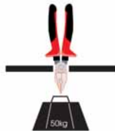
TEST DE ADHERENCIA DE MANGOS TESTING OF ADHESIVENESS TEST D'ADHERENCE KLEBTEST
